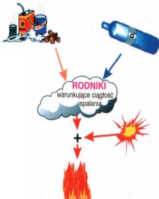
Rys. Warunki spalania: utleniacz, paliwo, źródło ciepła i rodniki warunkujące ciągłość spalania
